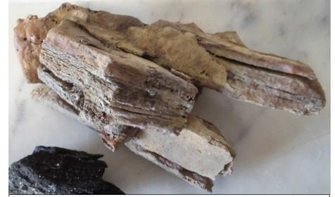
Im Bild sieht man Mansfelder Schiefer der mit einer Temperatur **unterhalb** von 1250°C **gesintert** wurde. Die Schiefer sind nur miteinander verklebt und braun verfärbt, aber eben nicht total geschmolzen. Das bedeutet, dass Mansfelder Kupferschiefer vor 1199, also vor Nappian und Neuecke nicht verarbeitet werden konnte
