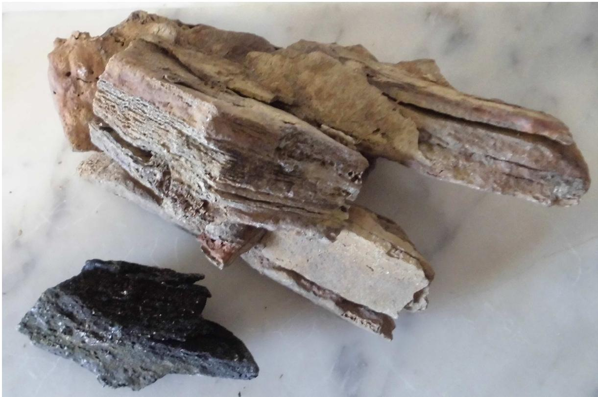
**Im Bild:** Kupferschiefer verschmolzen bei ca. 1000°C und damit unterhalb der Temperatur von 1250°C bei der dieser erst schmelzflüssig wird. Dieser Schiefer wurde **gesintert**.
