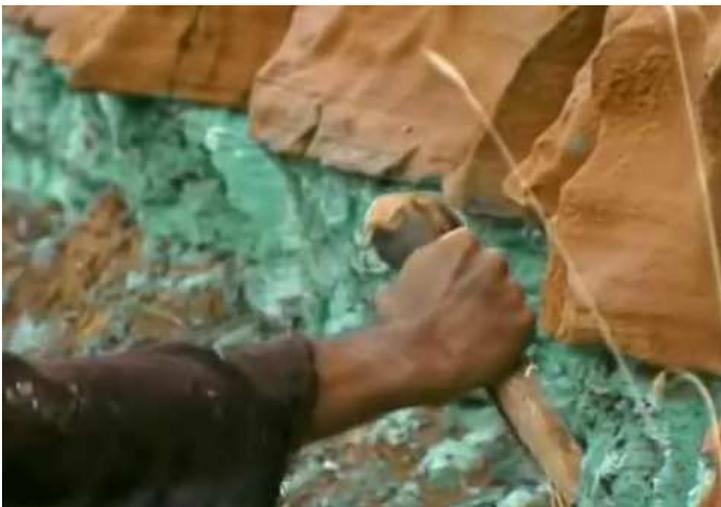
Mit Hilfe von Werkzeugen aus Stein, Holz, Knochen und Horn, erfolgte der Abbau von Malachit
