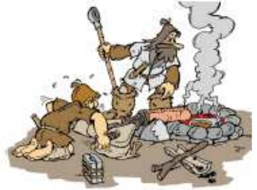
Dann wird das flüssige Kupfer in die vorbereitete, aufrechtstehende Gussform gegossen. Dieser Prozess ist sehr schwierig. Läuft der ganze Vorgang richtig ab, kann man damit rechnen, einen brauchbaren Rohling zu erhalten.
