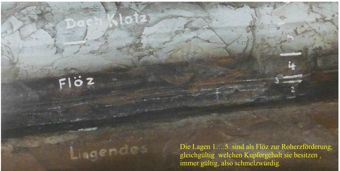
Die **erzführende Zone** im bergmännischen Aufschluss im Bernard—Koenen-Schacht I (Niederröblingen) 8.Sohle. In grauschwarzen Farben ist das **Kupferschieferflöz** die metallführende Zone deutlich zu erkennen. Das Liegende bildet hier das Zechstein-Konglomerat, im Hangenden steht der massive Zechsteinkalk (Dachklotz) an.
